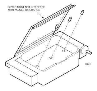
THE NOZZLE IS TO BE PLACED TOWARD THE FRONT OF THE APPLIANCE TO MINIMIZE THE POTENTIAL FOR THE SKILLET OR BRAISING PAN COVER TO INTERFERE WITH THE NOZZLE DISCHARGE.
